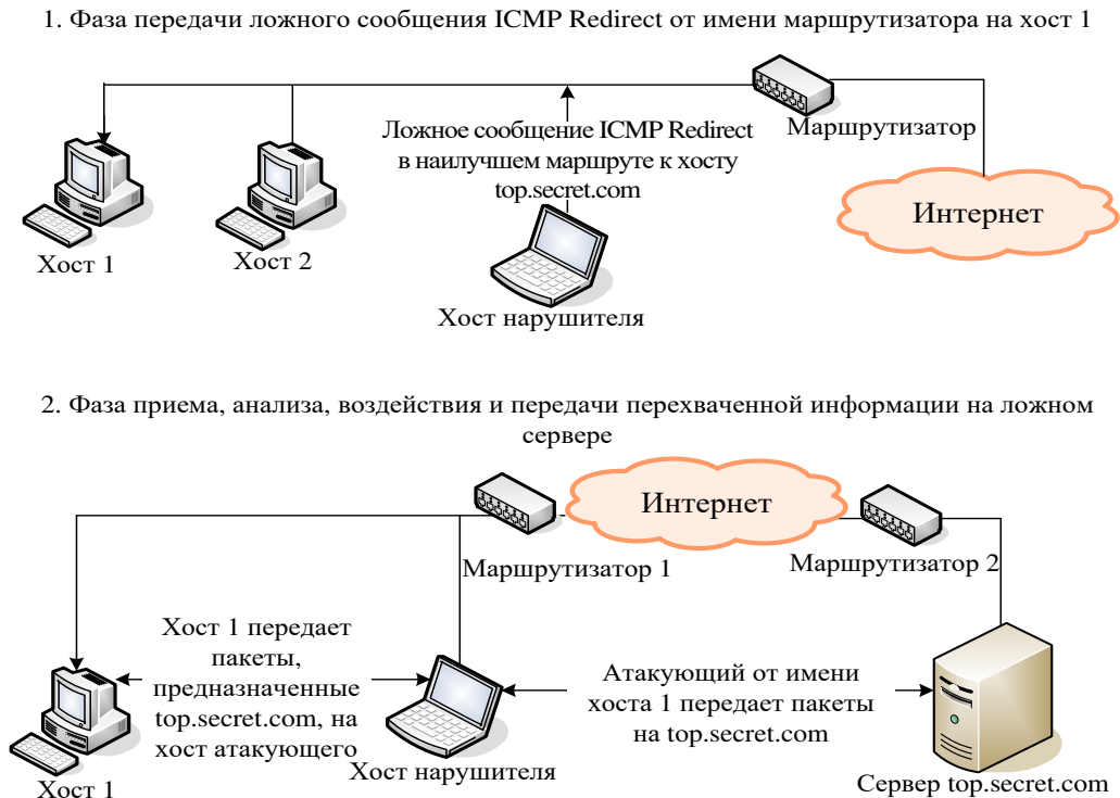
Рисунок 9. Схема реализации угрозы «Навязывание ложного маршрута» (межсегментное) с целью перехвата трафика
